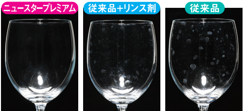
※評価条件: グラスにモデル汚れ(タンパク質汚れ)を塗布し、30分乾燥。洗浄機内にモデル汚れ(タンパク質汚れ)を共存させ洗浄。これを5回繰り返し洗った。
